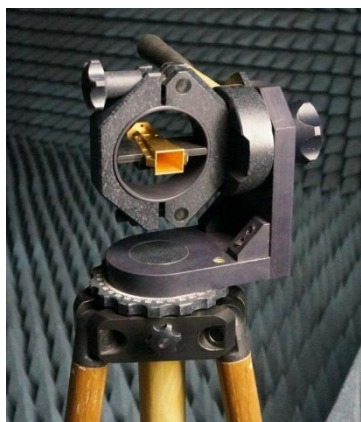
Фото 1. Антенна П6-135 на диэлектрическом штативе ШАД-01
