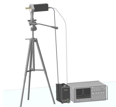
Рис. 4 Антенна П6-135 с преобразователем частоты СК5РТ 75-90/3-18 WR12 (90-105(110)/3-18(23) WR10)
